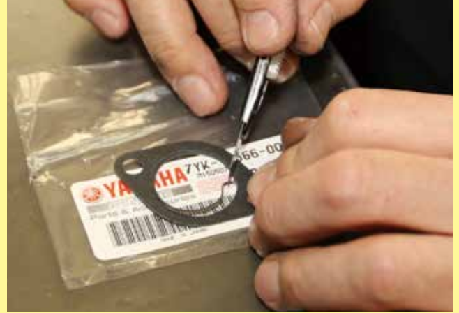
交換用ガスケットはカッターで、少しだけ内径を切り広げておく。マニホールドとジョインターに押しつぶされて広がった部分がはみ出してこないようするための処置だ
