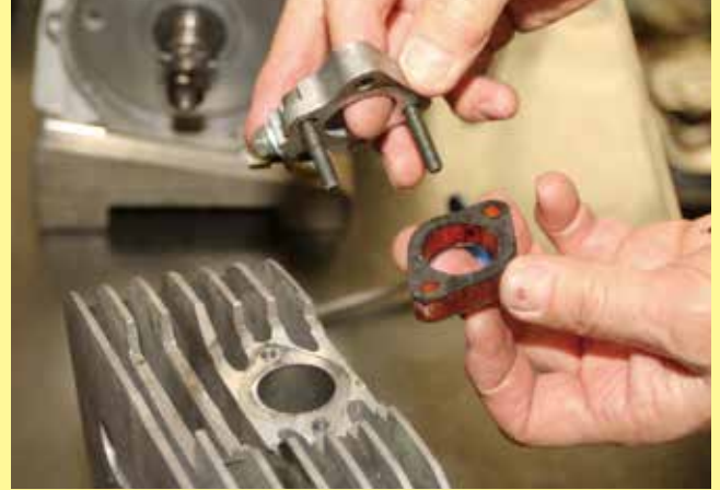
マニホールドジョイントをシリンダーから取り外すには2本のボルトを緩めればOK。今回はガスケットも段差の原因のためカッターでジョイントから剥がすことに
