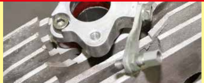
これで段差が解消された。吸入時におけるガスの性質としては壁面に反って流れる特徴がある。また上側よりも下側に向かって気流が流れることも覚えておこう
