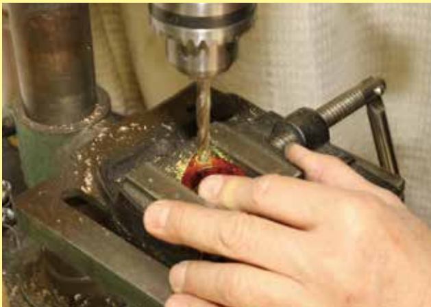
ジョイントのボルト取付穴に余裕を持たせて位置を調整できるようにするため、電動ドリルを使って取付穴の直径を広げる。6.5mm～7mmほどにしておけば間に合うだろう
