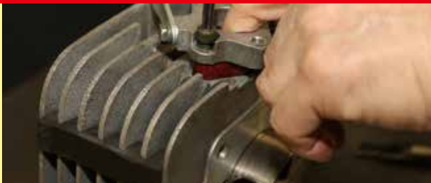
シリンダー取付時は壁面部分を指で滑らせつつ段差が生じないような位置に調整する。どうしても段差ができる場合はクランク側(下側)を優先的にフラットにしよう
