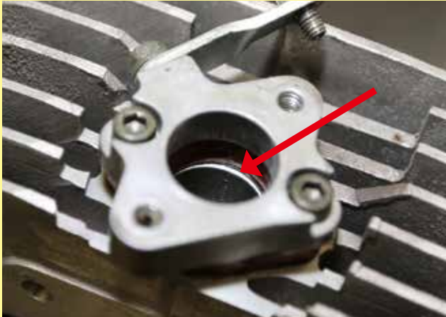
マニホールドジョイント、ガスケット、そしてインシュレーターとの重なる部分に、それぞれ僅かながらの段差が生じている。これが吸入時の抵抗となってしまうのだ
